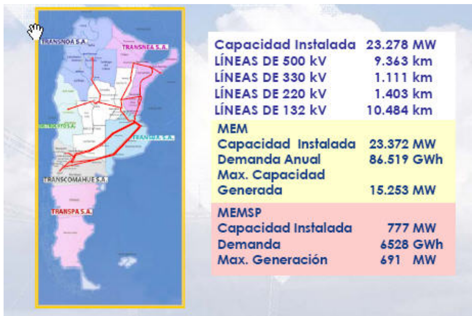
Figura 2. Esquema de potencia instalada (Fuente: Taller de Integración Energética Regional. Transener. Marzo 2005)
