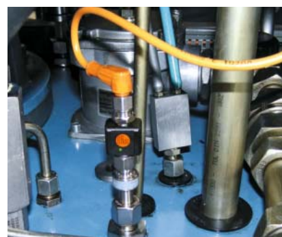
Utilización de un transmisor modular TP en lugar de un transmisor de cabezal o con montaje en carril DIN.
