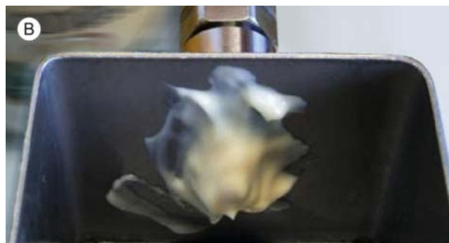
(A) El LMT supervisa el nivel de llenado de mayonesa mediante espectroscopia de impedancia. (B) A pesar de los residuos depositados sobre el sensor, se detecta el depósito vacío de forma eficaz.
