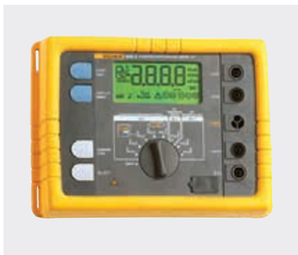
Los medidores de resistencia de tierra de cuatro polos funcionan mejor para medidas de resistencia baja porque tienen una clavija adicional que ayuda a eliminar la resistencia de los cables de prueba en la medida de resistencia que aparece en la pantalla.
