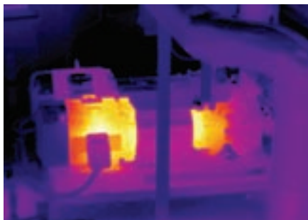
Figura 5-27. La termografía se puede utilizar para determinar cuando un equipo no está funcionando correctamente. La imagen térmica del grupo motor-bomba en la parte trasera indica que se ha detenido sin motivo aparente.
