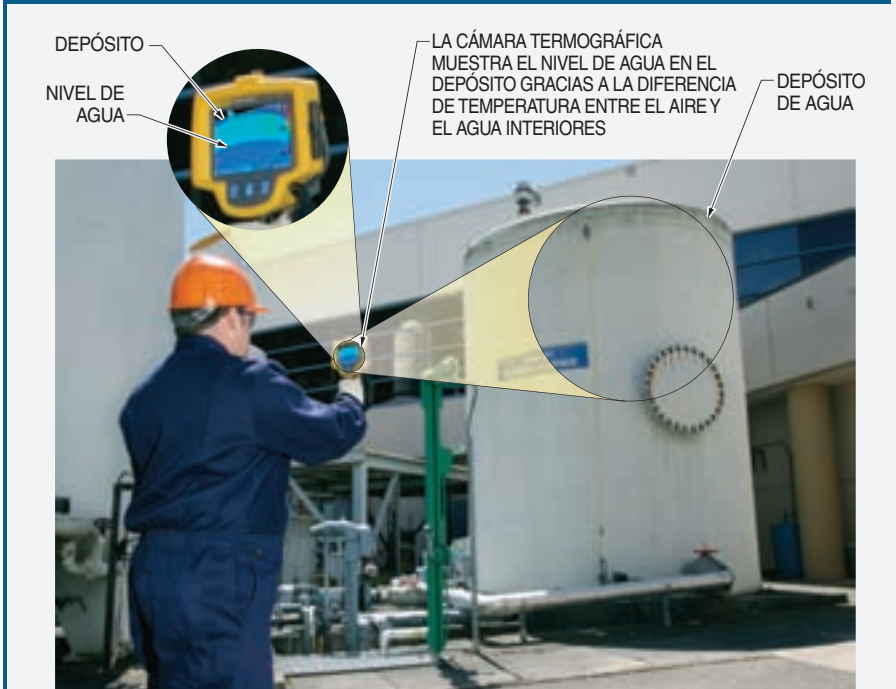
Figura 6-4. Una de las aplicaciones más comunes en termografía es la localización o confirmación de niveles de material en recipientes como depósitos o silos.
