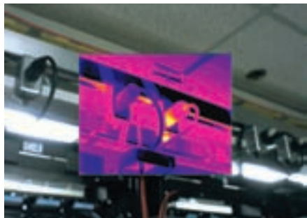
Figura 5-81. La conexión eléctrica de la derecha de un grupo de servidores muestra un patrón térmico que indica que existe una conexión con una alta resistencia o que hay un problema en el cableado interno.
