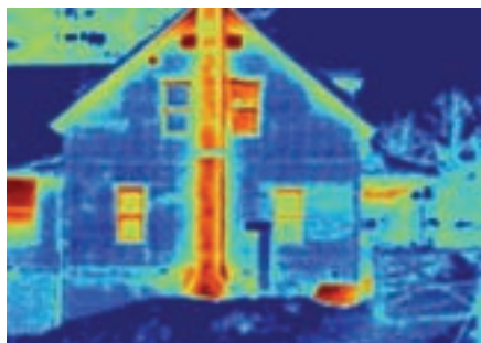
Figura 5-48. La imagen térmica desde el exterior de un edificio puede mostrar claramente zonas con problemas, como las zonas más claras donde falta aislamiento.
