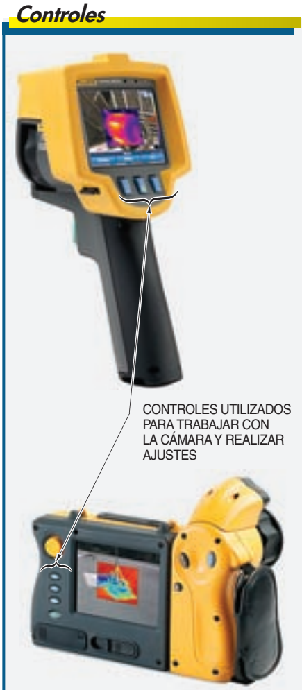
Figura 1-6. Con los controles, se pueden realizar ajustes sobre variables importantes como el rango de temperaturas, el intervalo y nivel térmico, así como otros ajustes.
