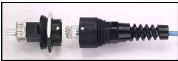
Figura 8: Conector RJ-45 IP67 Etherseal ®, fabricado por TYCO dentro de su programa AMP Netconnect. Forma parte de un sistema integral de cableado industrial Cat 5e compuesto por tomas completas, paneles y cables especialmente diseñados para este medio.
