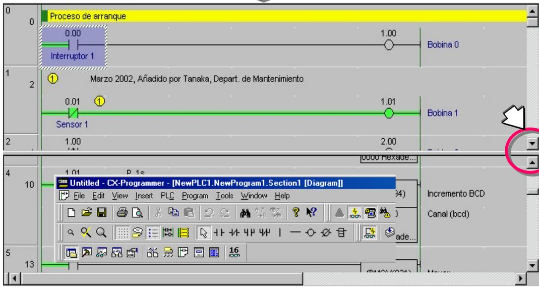
La pantalla se divide en dos paneles, superior e inferior, y puede visualizar cualquier dirección en los dos paneles respectivamente mediante el uso de las barras de desplazamiento.
