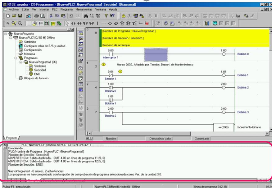
Los errores y las direcciones se muestran en la ventana de salida.
