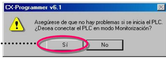
Si el programa tiene una gran cantidad de datos, la velocidad de desplazamiento de la pantalla puede ser lenta al monitorizar. En tal caso, haga clic en el icono siguiente para cancelar la monitorización, desplace la pantalla a la dirección que desee monitorizar y, a continuación, vuelva a cambiar al modo de monitorización.
