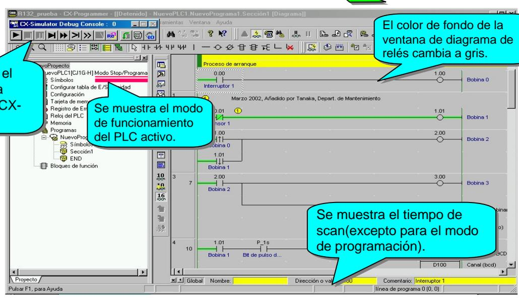
Se muestra el modo de funcionamiento del PLC activo.
