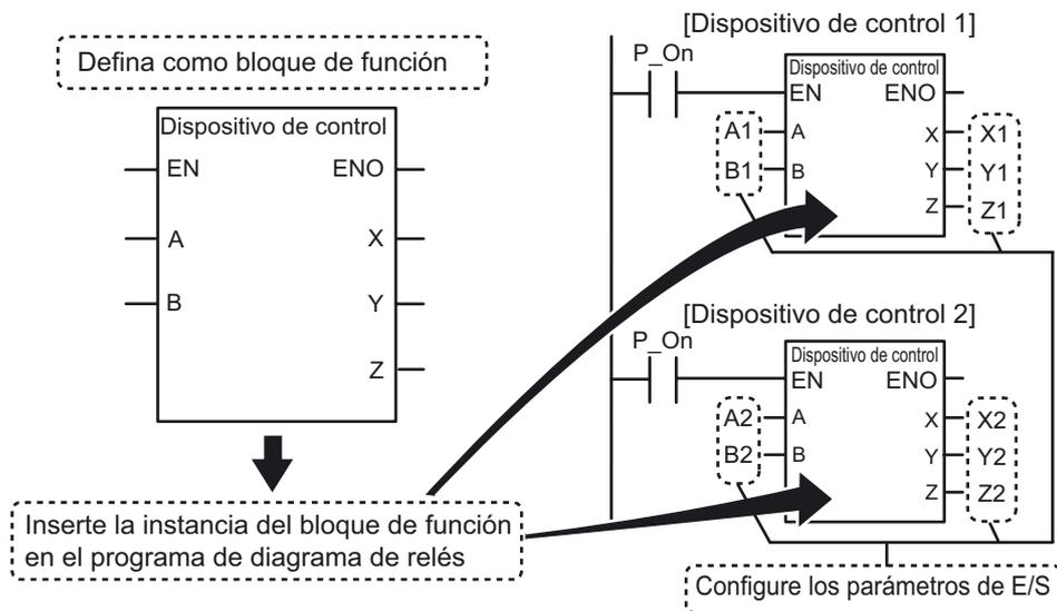
El bloque de función definido puede utilizarse en los programas de diagrama de relés como instancias de bloques de función.
