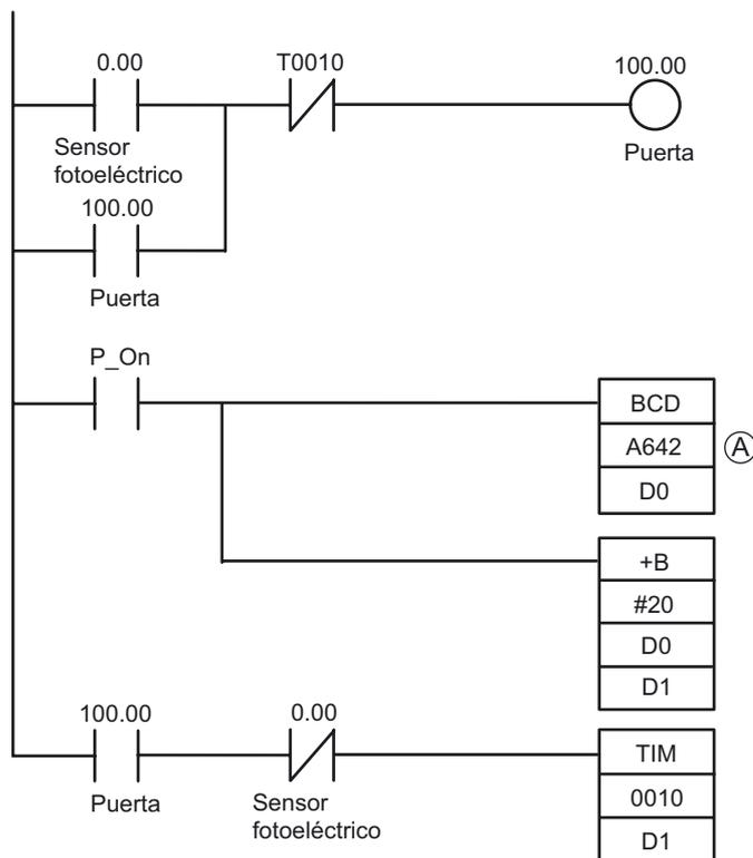
(A): Para utilizar el potenciómetro analógico en la unidad CP1L o CP1E con el objeto de ajustar el temporizador en la aplicación del ejemplo, cambie el área auxiliar A643 del programa de diagrama de relés por A642.
