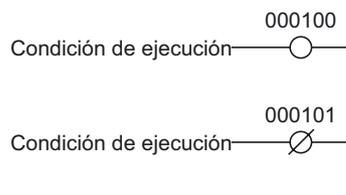
**Nota** No utilice simultáneamente bobinas con el mismo número de relé para OUT y OUT NOT. Si lo hace, se producirá un error de programa "bobina duplicada".
