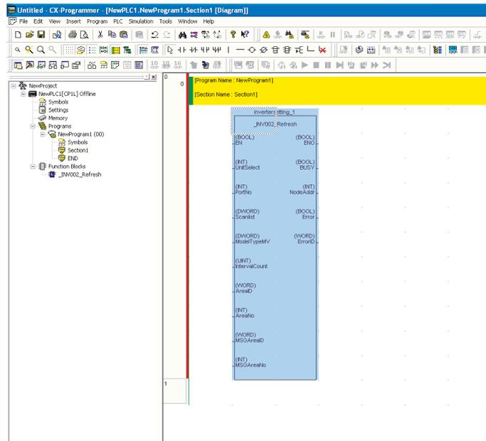
8. **Conecte un contacto de entrada al bloque de función.**
