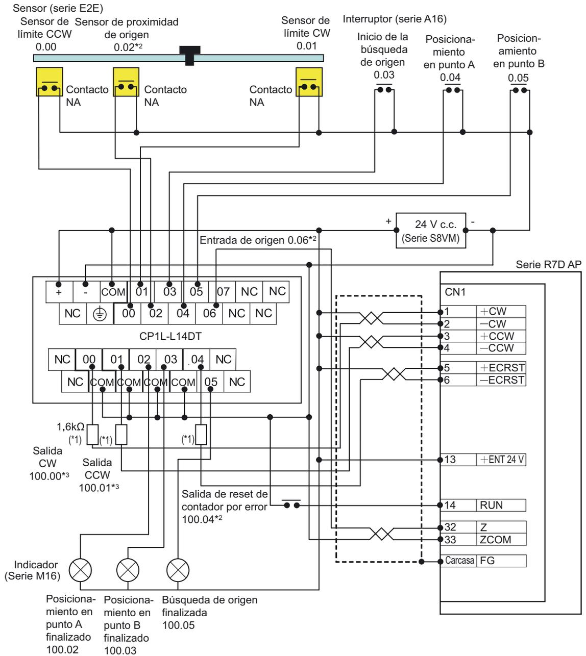
\*1 Inserte una resistencia de 1,6 a 2,2k Ω , de modo que la corriente esté dentro del rango de 7 a 15mA.
