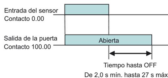
El tiempo transcurrido hasta el cierre de la puerta se ajustará mediante una resistencia variable conectada a la unidad CP1L.
