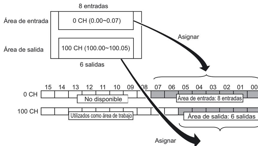
En las unidades de 14 puntos de E/S, 8 relés de entrada – desde 0.00 a 0.07 (bits 00 hasta 07 en 0CH) – son asignados al bloque de terminales de entrada. Asimismo, 6 relés de salida – desde 100.00 a 100.05 (bits 00 hasta 05 en 100CH) – son asignados al bloque de terminales de salida.
