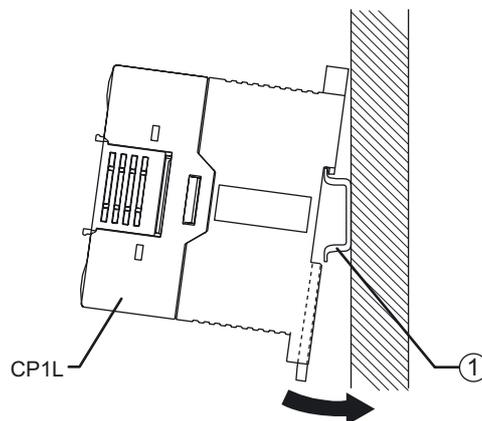
3. **Inserte el pin de montaje para carril DIN (1) para inmovilizar la unidad CP1L.**
