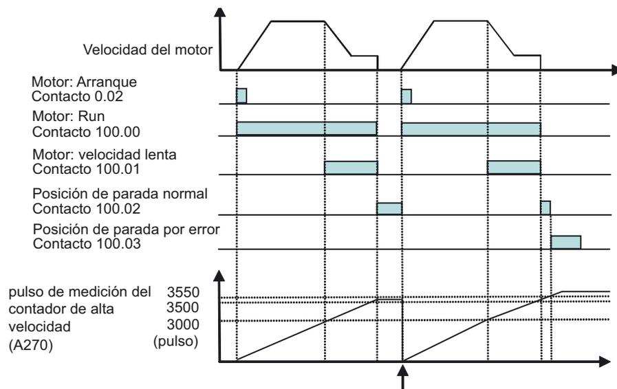
El programa de diagrama de relés pone en ON el reset de software de alta velocidad (A531.00) al arrancar el motor
