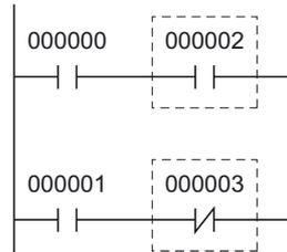
**Nota** No existe límite para el número de contactos que pueden conectarse mediante instrucciones AND/AND NOT.
