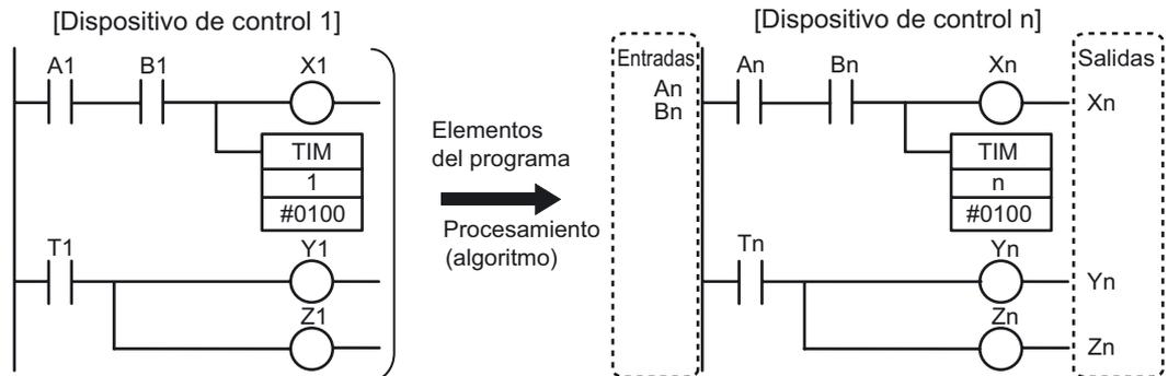
Tome un programa de diagrama de relés para "Control del dispositivo 1". Sustituya las E/S del programa por parámetros. Guarde el algoritmo en forma de plantilla.
