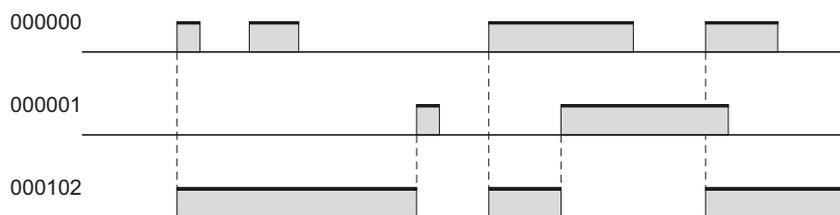
En el ejemplo precedente, la bobina de relé 000102 es puesta en ON por la condición SET, y en OFF por la condición RSET.
