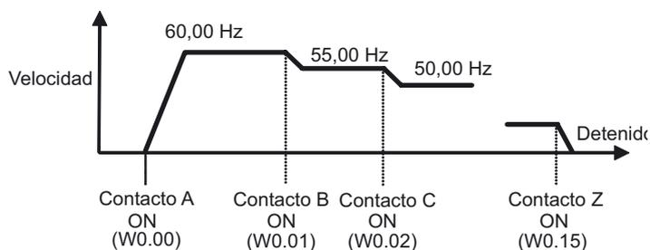
La velocidad objetivo se consigue en base a la entrada procedente de múltiples contactos. Los valores de aceleración y deceleración son modificados mediante la aceleración y deceleración de un variador.
