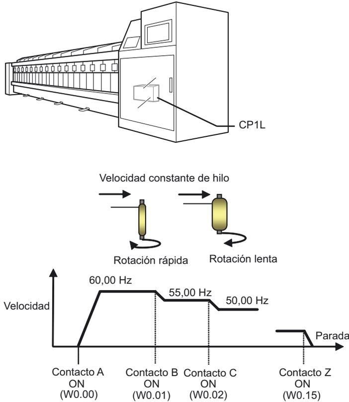
La velocidad objetivo se consigue en base a la entrada procedente de múltiples contactos. Los valores de aceleración y deceleración son modificados mediante la aceleración y deceleración de un variador.
