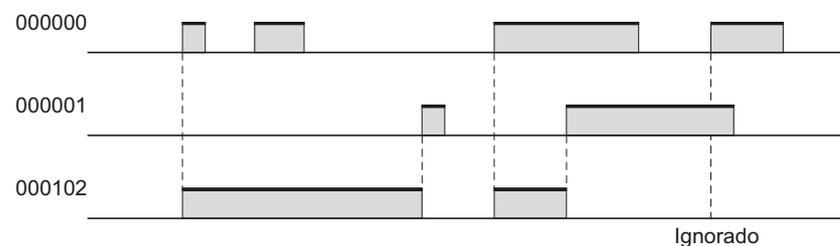
En el ejemplo precedente, la bobina de relé 000103 es puesta en ON por la condición SET, y en OFF por la condición RSET. Mientras la entrada de RSET esté en ON, la entrada de SET será ignorada.
