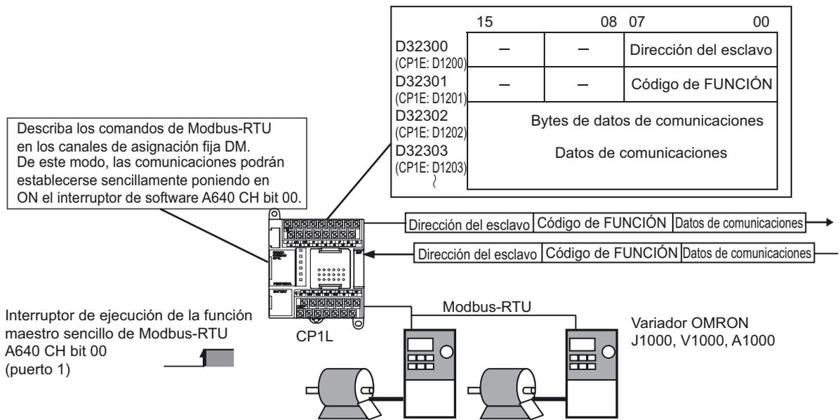
En los canales de asignación fija DM de maestro sencillo de Modbus-RTU, asigne la dirección de esclavo, la función y los datos al dispositivo esclavo de Modbus. Una vez realizadas las asignaciones, podrán enviarse comandos de Modbus-RTU situando en ON el conmutador de software. Las respuestas recibidas se guardan automáticamente en los canales de asignación fija DM.
