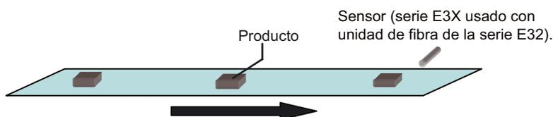
Las señales más cortas que el ciclo de scan deben ser leídas y contadas. Una vez contadas 100 señales, se producirá la salida de una señal de recuento completa.
