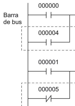
**Nota** No existe límite para el número de contactos que pueden conectarse mediante instrucciones OR/OR NOT.
