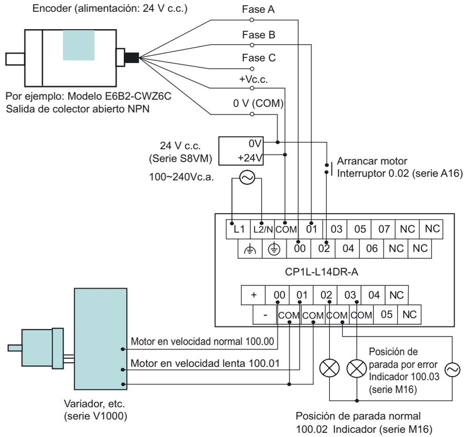
**Nota** Utilice la fuente de alimentación externa solamente para los dispositivos de entrada. (No se puede utilizar para alimentar dispositivos de salida.)
