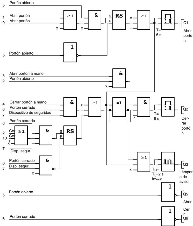
Con los pulsadores de arranque ABRIR PORTÓN o CERRAR PORTÓN se inicia el desplazamiento del portón, a no ser que esté activado el sentido contrario. El desplazamiento concluye mediante el respectivo interruptor final. El cierre del portón es interrumpido asimismo por el dispositivo de seguridad.
