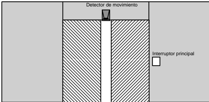
La mayoría de las veces, la puerta es accionada por un motor que la desplaza a través de un acoplamiento elástico. Se evitan así las posibles lesiones de personas que queden aprisionadas. El control entero está conectado a la red a través de un interruptor principal.
