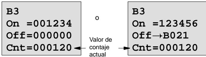
Los umbrales de conexión y desconexión (On, Off) se pueden modificar. Eso no es válido si el umbral de conexión y desconexión es el resultado de otra función (en el ejemplo B21, vea el capítulo 4.4.13).
