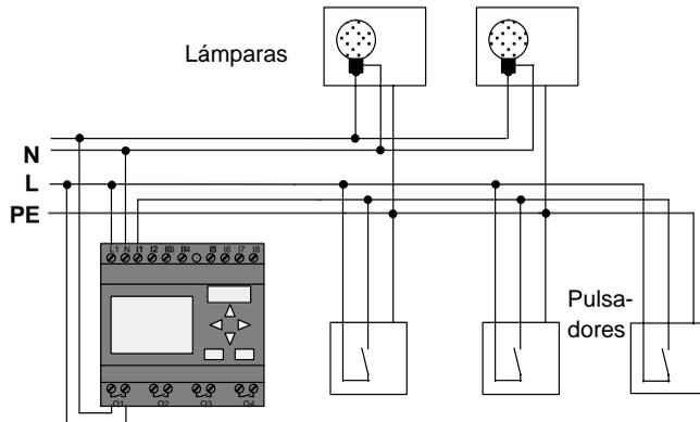
El cableado exterior de la instalación de alumbrado con LOGO! no se diferencia del alumbrado normal de escaleras o pasillos. Sólo es sustituido el interruptor automático de escalera o, en su caso, el relé de impulsos. Las funciones adicionales se indican directamente en LOGO!.
