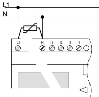
Para picos de tensión, utilizar un varistor (MOV) con una tensión de servicio como mínimo un 20% superior a la tensión nominal.
