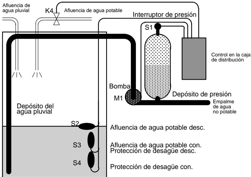
El agua pluvial se recoge en un depósito colector. Un sistema de bombeo inyecta el agua del depósito colector en una canalización prevista con este fin. Desde esta red puede tomarse entonces el agua pluvial igual que sucede con el agua potable. Si llegara a vaciarse el depósito, es posible rellenarlo con agua potable.
