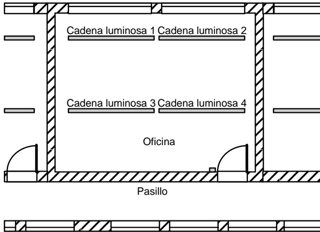
Al planificar instalaciones de alumbrado en recintos comerciales se determinan el tipo y la cantidad de lámparas en función de la intensidad luminosa deseada. Por razones de rentabilidad, se utilizan a menudo tubos fluorescentes dispuestos en forma de cadenas luminosas. La asignación de éstas a distintos grupos conectables depende del aprovechamiento previsto para el recinto.
