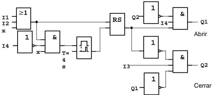
Este es el diagrama funcional equivalente al esquema de circuitos de la solución convencional.
