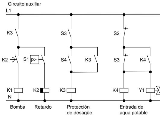
La bomba y una válvula magnética son controladas a través de un interruptor de presión y 3 interruptores de flotador, situados en el depósito de agua pluvial. La bomba debe activarse cuando no se alcance la presión mínima en la caldera. Una vez alcanzada la presión de servicio, al transcurrir el tiempo de marcha por inercia de varios segundos, la bomba se vuelve a desconectar. Se prevé este retardo para impedir la activación/desactivación continua durante una toma de agua prolongada.
