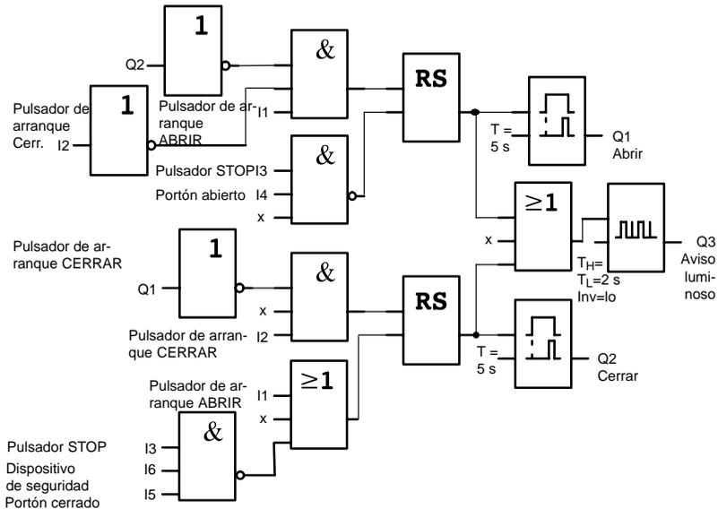
Con los pulsadores de arranque ABRIR o CERRAR se inicia el desplazamiento del portón, a no ser que esté activado el sentido contrario. El desplazamiento concluye accionando el pulsador STOP o mediante el respectivo interruptor final. El cierre del portón es interrumpido asimismo por el dispositivo de seguridad.
