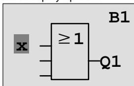
El primer elemento de la lista **Co** es el símbolo correspondiente a “Entrada no utilizada”: una 'x'. Elija mediante las teclas ▼ o ▲ la entrada I1 .
