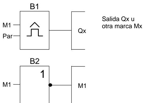
2. Parametrice el interruptor de valor umbral de la siguiente manera. Con la negación de la marca se genera un impulso en cada ciclo de programa. El intervalo de tiempo del interruptor de valor umbral se ajusta a 2 segundos.
