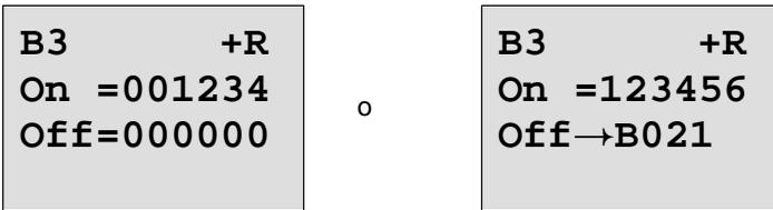
Si el bloque referenciado (en el ejemplo B21) proporciona un valor fuera del rango de validez, se redondea hacia arriba o hacia abajo hasta el siguiente valor válido.
