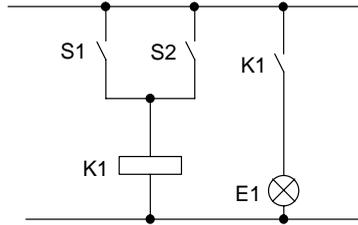
El interruptor S1 o el S2 conecta el consumidor. para LOGO! la conexión en paralelo de los interruptores es un 'O' porque los interruptores S1 o S2 activan la salida.
