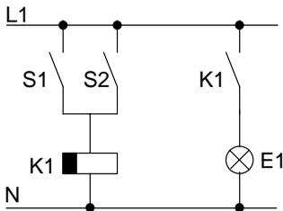
La primera parte del circuito ya es conocida. Los dos interruptores S1 y S2 conectan un relé. Este relé debe activar el consumidor E1 y desactivarlo con 12 minutos de retardo.
