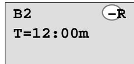
**Tipo de protección+:** el valor de tiempo T puede modificarse en modo de parametrización
