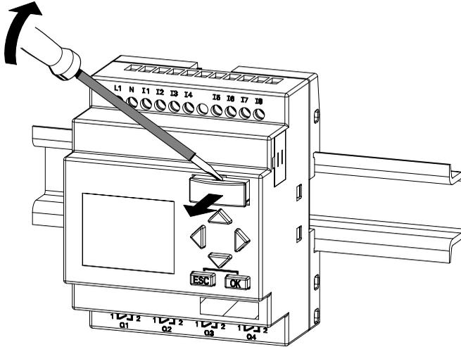
Introduzca un destornillador cuidadosamente en la ranura situada en el extremo superior del módulo de programa (Card) y suelte el módulo de programa (Card) ligeramente de la ranura.
