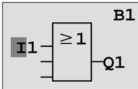
Pulse la tecla **OK**. I1 está conectada con la entrada del bloque O. El cursor salta a la próxima entrada del bloque O.
