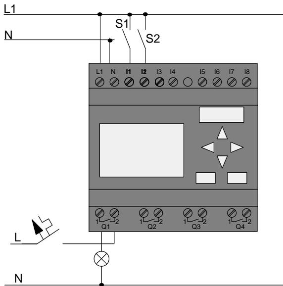
El interruptor S1 afecta a la entrada I1 y el interruptor S2 a la entrada I2. El consumidor está conectado al relé Q1.
