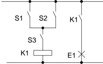
El consumidor E1 se activa y desactiva mediante los interruptores (S1  $\cup$  S2)  $\cap$  S3 (O=OR; Y=AND)
