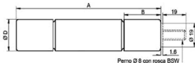
Fusible con placa de contacto tipo "A" (casquillo) se muestra con línea continua; la placa de contacto tipo "22" se muestra con línea punteada.
