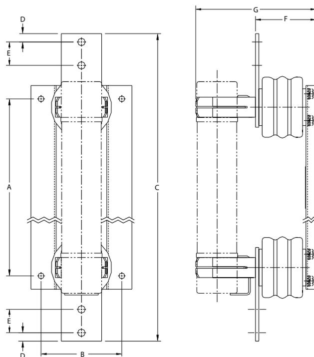
† Los montajes con desconector sólo deben usarse para extraer el fusible. No los utilice para seccionamiento de carga ni para desmontar fusibles mientras están energizados.
