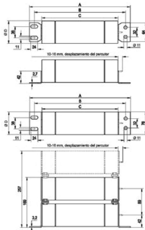
Fusible de triple barril (el tercer barril se muestra con línea punteada) con placas de contacto "03". El fusible de doble barril, con placas de contacto "02", se muestra con línea continua.
