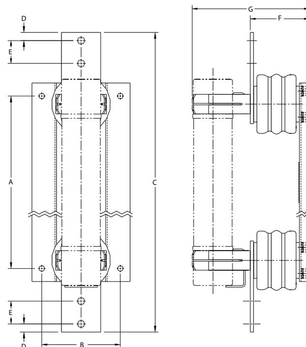
† Los montajes con desconector sólo deben usarse para extraer el fusible. No los utilice para seccionamiento de carga ni para desmontar fusibles mientras están energizados.
