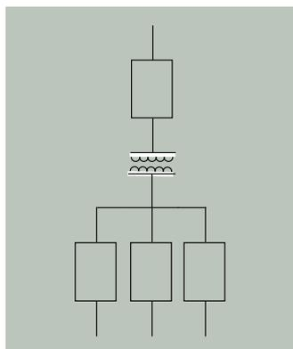
Figura 1. Protección del cable individual de salida
