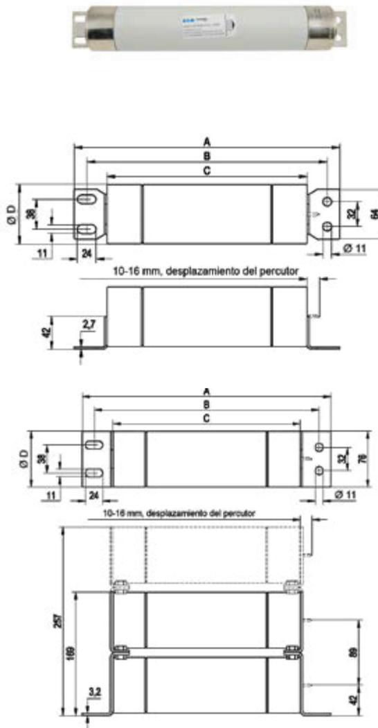
Fusible de triple barril (el tercer barril se muestra con línea punteada) con placas de contacto "03". El fusible de doble barril, con placas de contacto "02", se muestra con línea continua.
