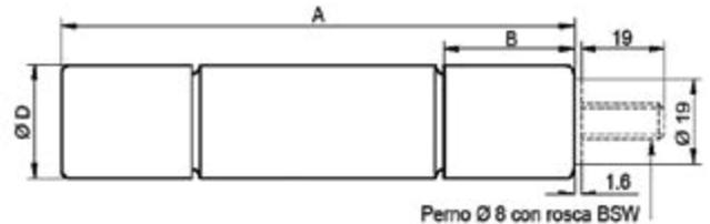
Fusible con placa de contacto tipo "A" (casquillo) se muestra con línea continua; la placa de contacto tipo "22" se muestra con línea punteada.
