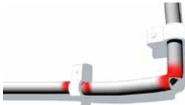
Foto 18.3 Ejemplo de aislación dañada por doblado
