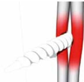
Foto 18.2 Ejemplo de aislación dañada por perforación
