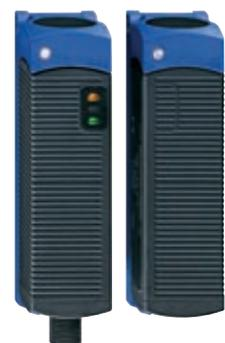
La vigilancia electrónica de guardas de seguridad móviles sumada al bloqueo mediante enclavamientos por solenoide sin contacto, permiten una detección del actuador sin necesidad de contacto ni desgaste alguno. La tecnología patentada de pulso-eco permite amplias tolerancias en la aproximación del actuador codificado, tanto en la distancia de conmutación como en la desalineación. A pesar de ello, los puntos de conmutación e histéresis son extremadamente reiterativos y constantes
