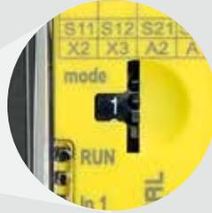
La configuración de funciones se realiza a través de un interruptor giratorio.
