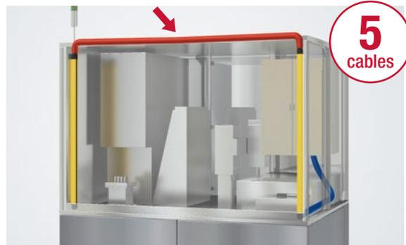
El transmisor recibe la alimentación del receptor, lo que significa que sólo el receptor tiene que estar conectado al panel de control.
