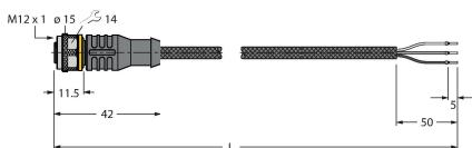
Cable de conexión, conector hembra M12, recto, 3 polos, longitud del cable: 2 m, material de la funda protectora: fibras de aramida, amarillo; pico de temperatura: 200 °C
