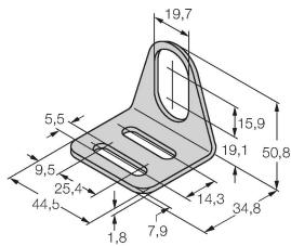
Soporte de montaje para sensores de tubo roscado; material: acero inoxidable A2 1.4301 AISI 304
