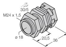
Abrazadera de montaje rápido con tope, material: Latón cromado. Rosca macho M24 x 1.5. Nota: La distancia de conmutación de los interruptores de proximidad puede variar por el uso de soportes de montaje rápido.
