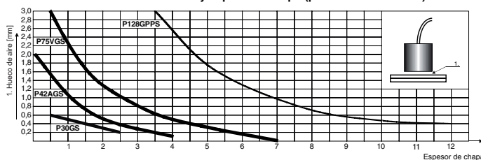
Máx. hueco de aire entre el sensor y la primera chapa (primer hueco de aire)
